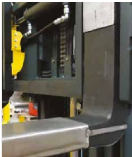
De hiel van de vork wordt open gehouden voor periodieke inspecties
