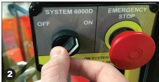
Stellen Sie sicher, dass der Not-Aus-Taster nicht betätigt wurde, und schalten Sie dann das system6000™ ein.
