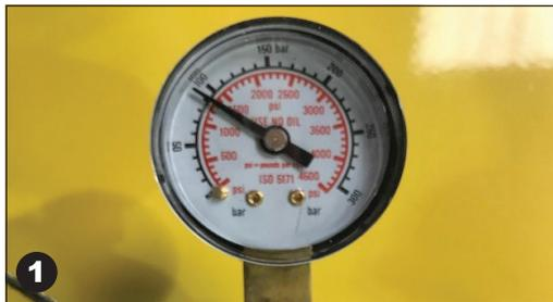
Öffnen Sie das Ventil an der Prüfgasflasche und stellen Sie sicher, dass das Messgerät anzeigt, dass sich Gas im Zylinder befindet. Das Messgerät sollte mehr als 20 bar lesen.
