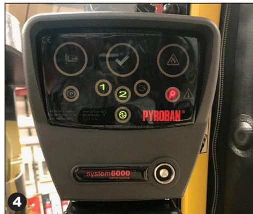
Der Fortschritt des Gastests beim Hochfahren wird durch die LED-Anzeigen 1, 2 und 3 angezeigt. Die LED 1 blinkt während der Anlaufphase und leuchtet dauerhaft nach Ablauf der Anlaufzeit. Die Dauer der Anlaufphase variiert je nach Systemzustand. Die Zeit für die Anlaufphase kann Null sein, wenn der Gaskopf bereits ausreichend lange eingeschaltet war.
