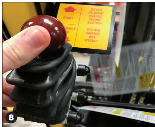
8 Halten Sie den Hebel des Luftenlass-Abschaltventils in der vorderen Position und starten Sie das Fahrzeug wie gewohnt mit dem Original-Fahrzeugschlüsselschalter. Sobald der Motor gestartet ist, warten Sie 3 Sekunden, bevor Sie den Hebel des Luftenlass-Abschaltventils loslassen. Dadurch kann der Motoröldruck das Ventil automatisch in der offenen Position halten. Weitere Hinweise zum Betrieb des Fahrzeugs finden Sie im Originalhandbuch des Fahrzeugs.
