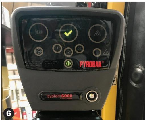
Nach erfolgreichem Abschluss des Gastests nach dem Hochfahren leuchtet der grüne Haken und zeigt an, dass das Flurförderzeug aktiviert ist. Schlägt der Gastest nach dem Hochfahren fehl, blinkt das Buchsymbol und die LED 2 oder LED 3 blinken weiter, um die Ursache des Fehlers anzuzeigen. Diese Startsequenz dauert ungefähr 1 Minute.
