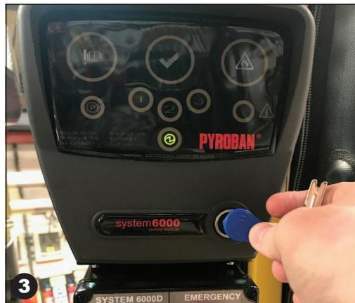
Legen Sie den blauen Dallas-Schlüssel auf den Schlüsselaufnehmer des Pyroban-Steuermoduls. Es ertönt ein Signalton und alle Anzeigen am Steuermodul leuchten gleichzeitig kurz auf, um den ordnungsgemäßen Betrieb zu bestätigen.
