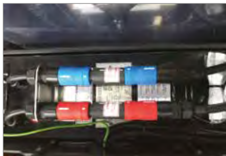
Tipikus Ex „e” akkumulátor (Figyelje meg a műszaki leírást és tanúsítványt tartalmazó jelölést a fedélen)
