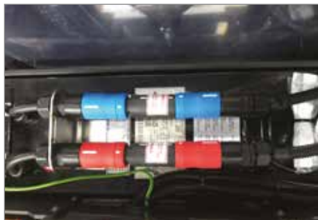
Typische Ex-e-Batterie (Beachten Sie das Spezifikations- und Zertifizierungsetikett auf dem Deckel)
