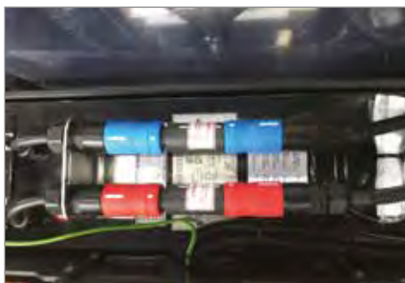
Tyypillinen Ex e -akku (Huomaa tekniset tiedot ja sertifiointimerkki kannessa)
